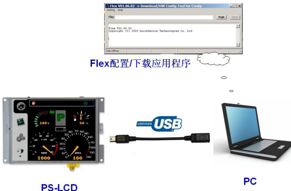
图 2-2 通过 Flex 下载界面文件到 PS-LCD 示意图
