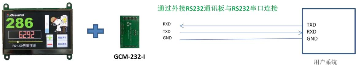
PS-LCD与用户系统RS232串口连接图
